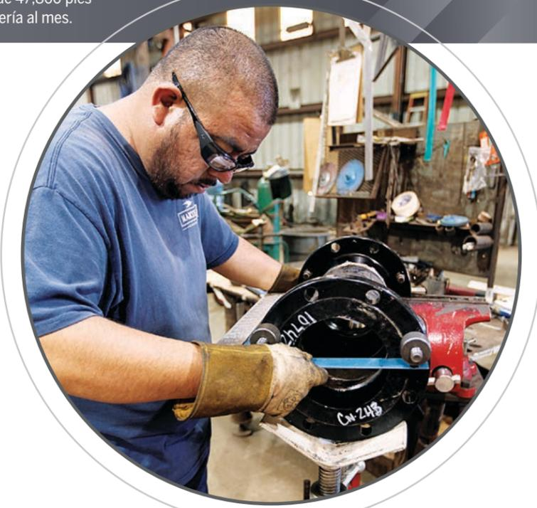
El obrero, **Sergio Banda**, revisa la enroscadura de un carrete de tubería de reborde.
